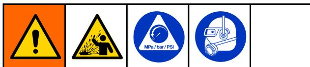
Данное оборудование будет оставаться под давлением до тех пор, пока оно не будет сброшено вручную. Во избежание получения серьезной травмы вследствие воздействия находящейся под давлением жидкости, например при ее попадании в глаза или на кожу, выполняйте процедуру сброса давления после остановки насоса и перед очисткой, проверкой или обслуживанием оборудования.
